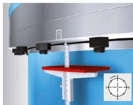
Figura 8: Estructura principal de la medición de asentamiento con calibrador de profundidades
