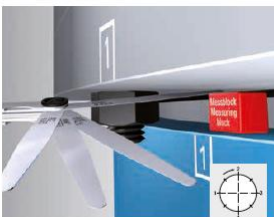
Figura 9: Estructura principal de la medición de asentamiento con calibre sensor
