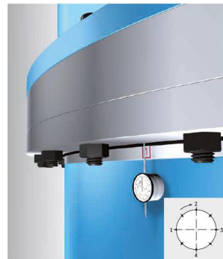
Figura 6: Estructura básica de la medición de la holgura de vuelo
