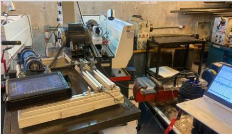
Se compara de forma iterativa con analizador de vibraciones
