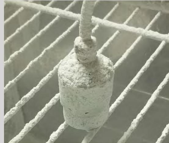
*IP6X: Prueba de entrada de polvo (en vacío) – 8 horas sin invasión*
