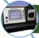
Espectrómetro RDE: Análisis de 24 elementos.
