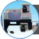
Espectrómetro infrarrojo (FTIR): Medición de AN, BN, oxidación, nitración, sulfatación, agua, hollín, glicol, aditivo (ZDDP).
