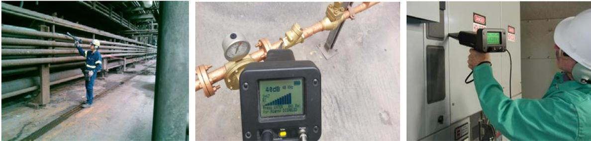
Fig. 1.1 El Ultrasonido tiene una amplia variedad de aplicaciones en las plantas industriales
