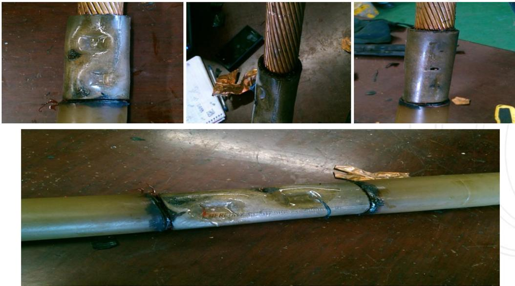
Fig. 1.20 Fotografías del interior del empalme donde se evidencian los daños que causaron la incidencia acústica detectada por el Ultrasonido Propagado en Aire/Estructuras
