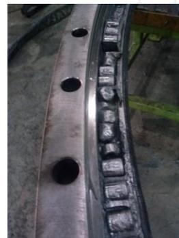
Fig. 1.18 Detección con Ultrasonido Propagado en Aire/Estructuras del Índice de Fricción del rodamiento y fotografías de cuando fue removido de operación.
