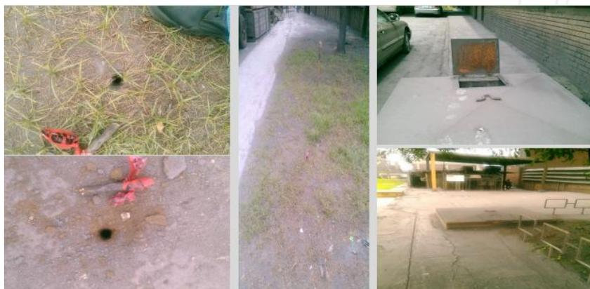
Fig. 1.8 Para el remonitoreo se hicieron 3 agujeros de 1.5 metros de profundidad en el suelo además de hacer el monitoreo y adicionalmente se revisaron los dos registros de la zona para garantizar que no hubiera presencia de gas natural.
